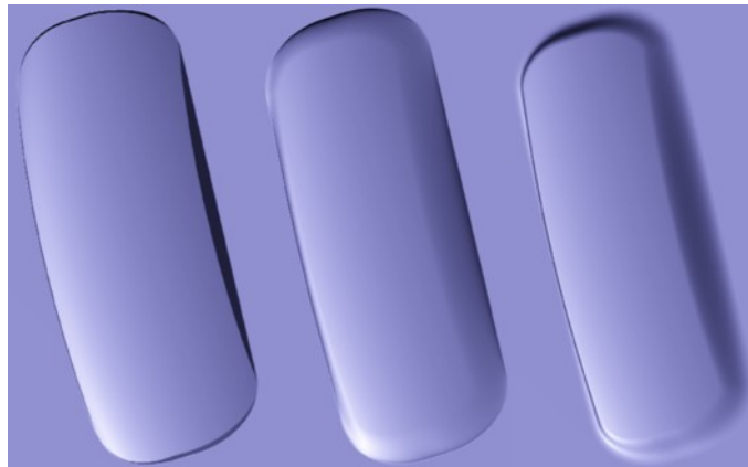
Ballige Fläche: planar Radius cubic.
